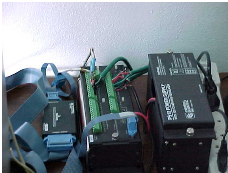
Figura 2 Datalogger da CAMPBELL SCIENTIFIC - INC modelo CR10X, com micrologger.
