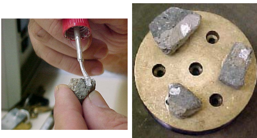
Figura 4.6 – Processo de preparação das amostras para sua metalização.
