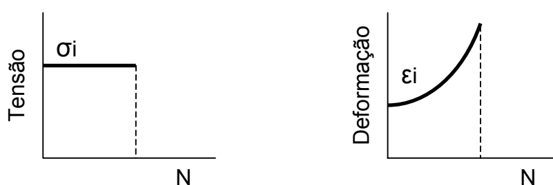
TENSÃO CONTROLADA - FM = -1
