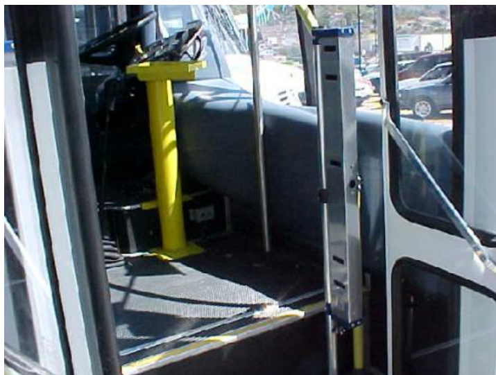
Figura 2.7 - Contador de passageiros instalado na porta do ônibus. Fonte: Folheto da Empresa do SISTEMA BREA (2005).
