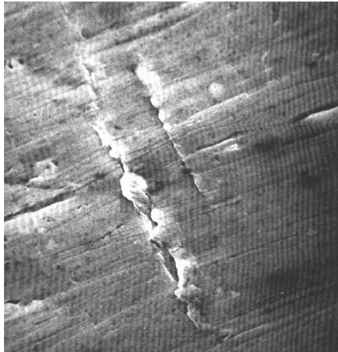
Figura 2.6: Estágio inicial do trincamento por fadiga em uma liga de alumínio após 10^3 ciclos. comprimento da microtrinca é de cerca de 20 \mu m [5]
