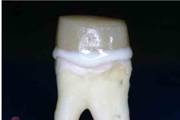
Figura 16: Restauração cerâmica posicionada sobre o corpo de prova, previamente, preparado.
