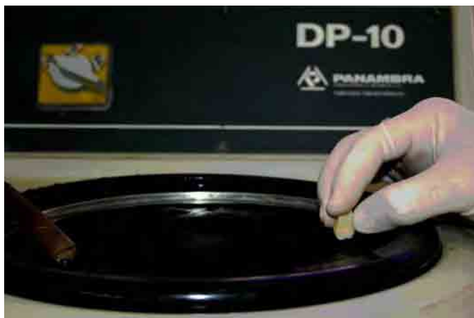
Figura 3: Polimento da superfície oclusal em politriz circular (Panambra Industrial Técnica, São Paulo, Brasil)
