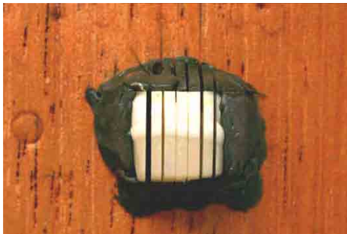
Figura 20: Corpo de prova cortado em placas de espessura de 2,0 milímetros.
