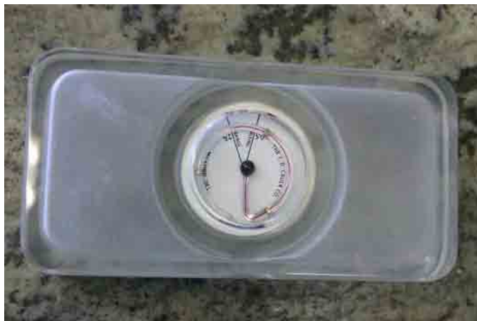
Figura 12: Placa de vidro com termômetro para manipulação do agente cimentante.
