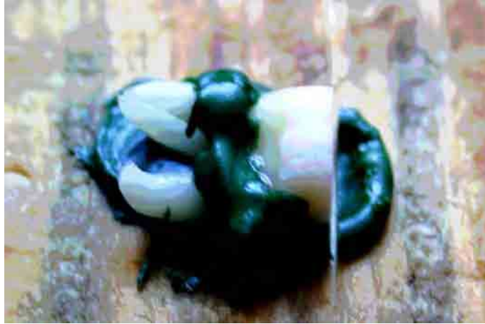
Figura 1: Elemento dental com a superfície oclusal cortada, fixado à base de madeira com godiva.
