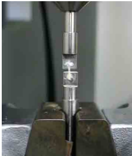
Figura 23: Espécime fixado pelas extremidades à dispositivo acoplado à máquina de ensaio universal MTS (Material Test System, MTS 810, USA).
