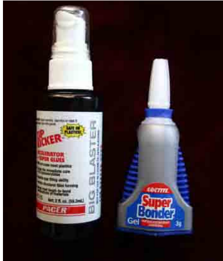
Figura 22: Adesivo e acelerador de presa empregados na fixação dos corpos de prova.
