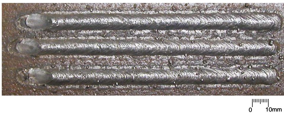
Figura 5.17: Cordões de solda sobre chapa utilizando eletrodos E7018 comprovando a flexibilidade e repetibilidade do processo.
