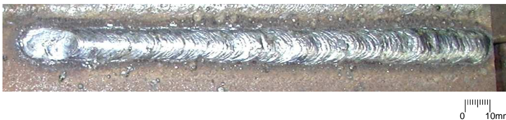
Figura 5.10: Aspecto do cordão de solda utilizando velocidade de 2,5mm/s, corrente de 180A e tensão de referência de 21V.
