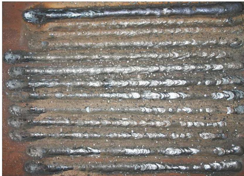
Figura 5.6: Cordões de solda obtidos durante os experimentos para regulagem do controlador.
