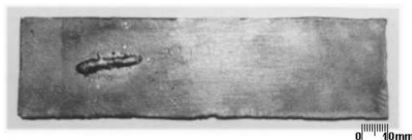
Figura 2.11: Cordão de solda depositado pelo sistema utilizando velocidade de mergulho constante [Oliveira, 2000].
