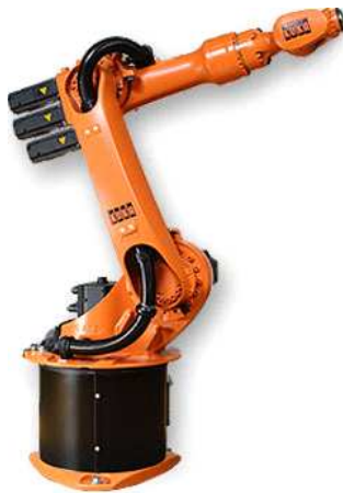
Figura 4.1: Robô industrial antropomórfico KUKA KR16 utilizado para validação da metodologia proposta.
