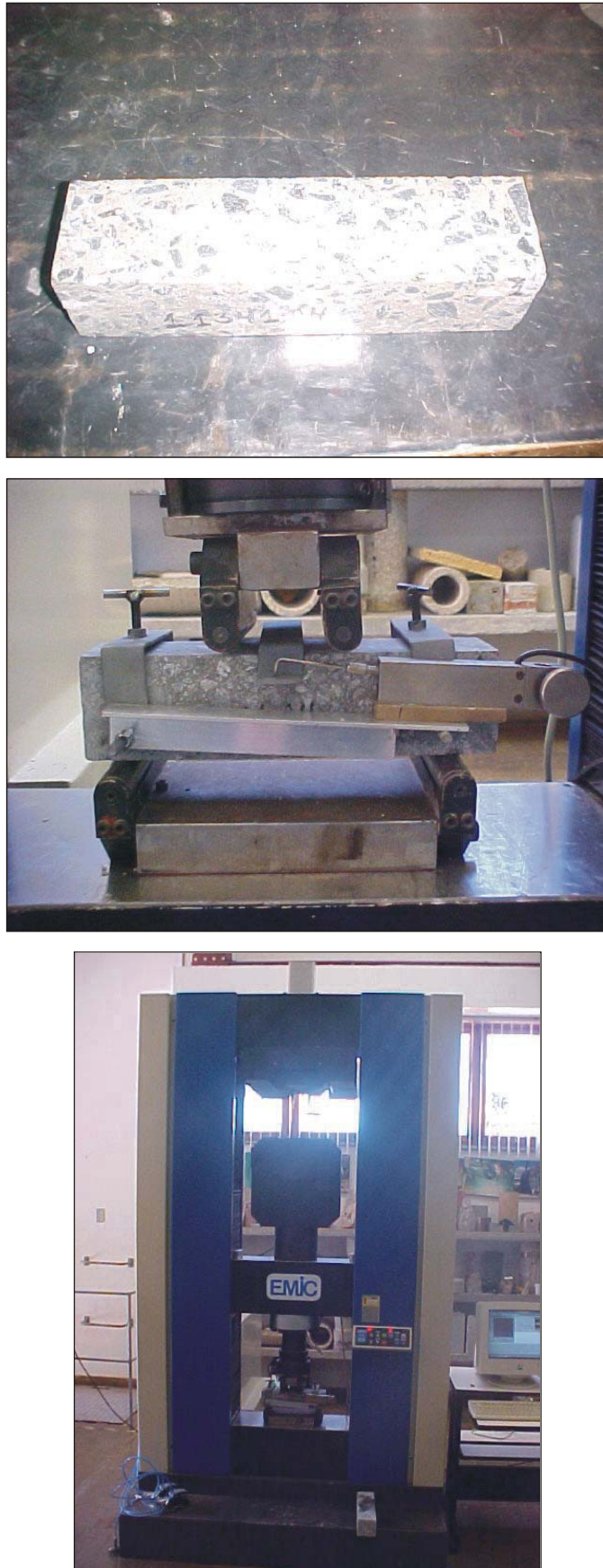
FIGURA D.1 – Corpo de prova e sistema de ensaio de tenacidade
