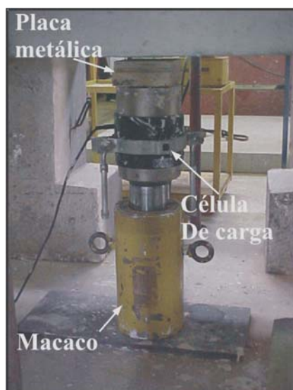
Figura 3.12 – Sistema de aplicação de carga (atuador hidráulico e célula de carga)
