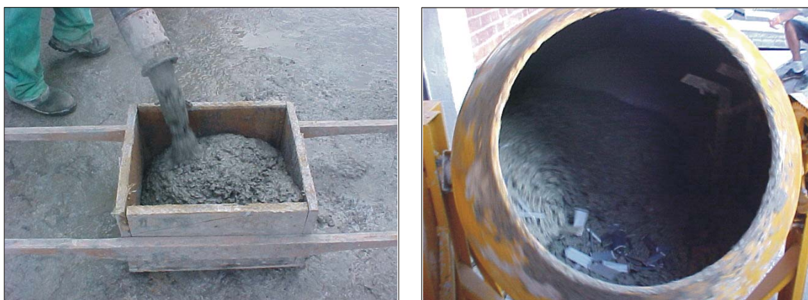
Figura 3.8 – Preparação do concreto com fibras
