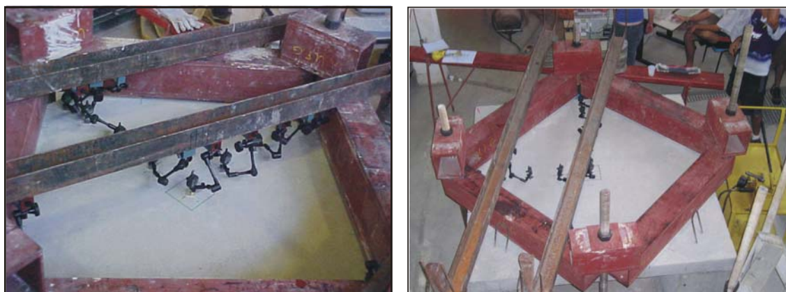
Figura 3.9 – Estrutura para fixação dos relógios comparadores
