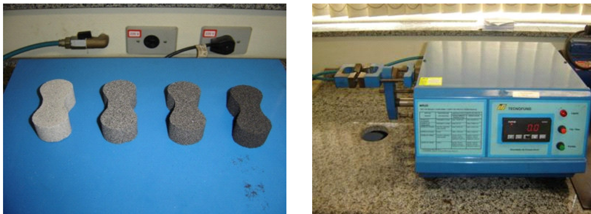
Figura 47 – Corpos de prova e máquina de ensaio de tração
