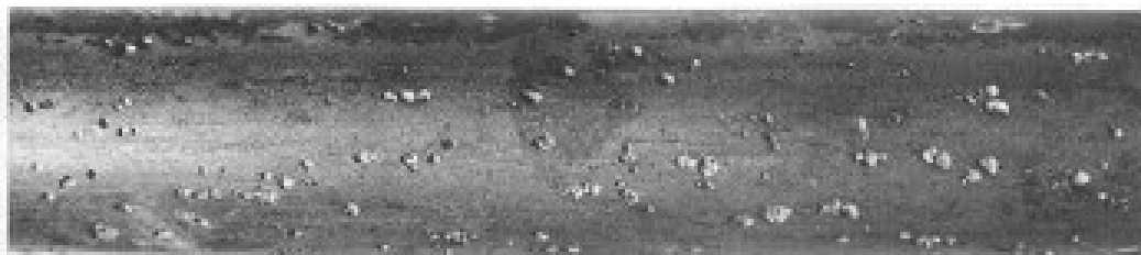
Figura 1.1 – Tubo de aço inoxidável com ataque por pite [GENTIL, 1996].
