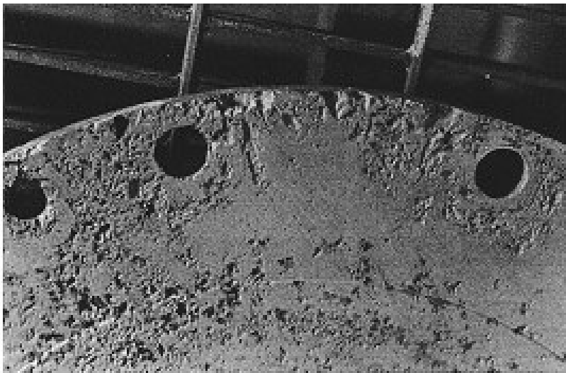
Figura 1.2 – Agrupamentos de pites numa centrífuga de aço inoxidável 316 [ASM, 1996]
