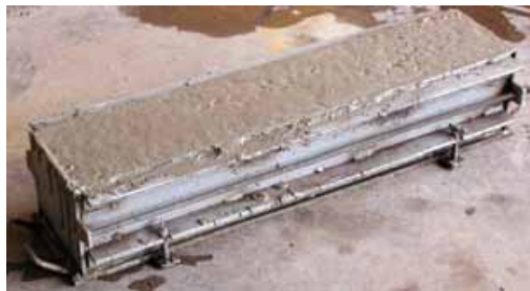
Figura 6.3 – Moldagem do prisma.
