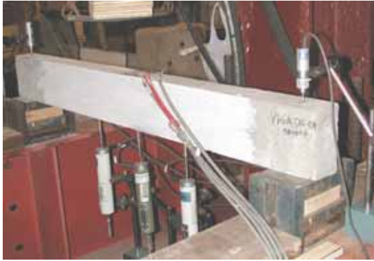
Figura 6.54 – Viga de concreto armado – Transdutores de deslocamento - Ensaio estático-dinâmico.
