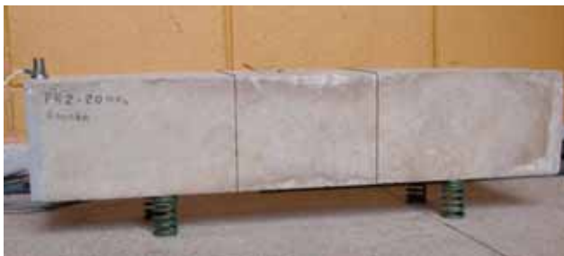
Figura 6.11 – Ensaio dinâmico – amostra íntegra.
