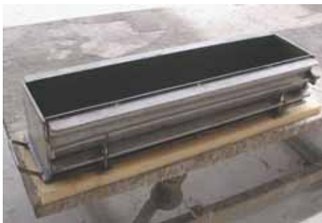
Figura 6.2 – Forma metálica - prisma. Mesa vibratória.
