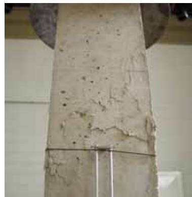
Figura 6.35 – Ruptura por esmagamento do concreto.
