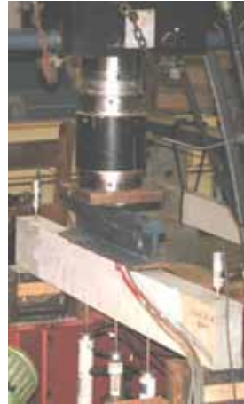
Figura 6.55 – Aplicação do carregamento estático – Atuador servo-hidráulico.
