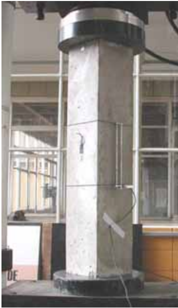
Figura 6.17 – Aplicação do carregamento estático – prisma.
