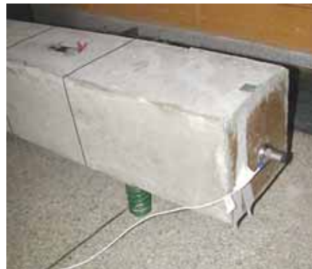
Figura 6.15 – Ensaio dinâmico – frequência longitudinal.
