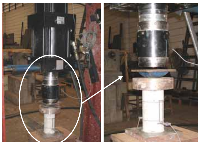
Figura 6.7 – Ensaio estático do CP cilíndrico no atuador.
