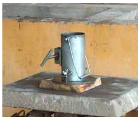
Figura 6.46 – Fôrma metálica dos CPs cilíndricos.
