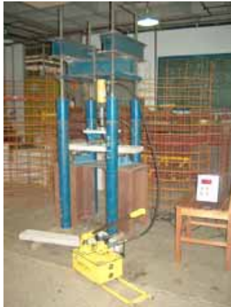
Figura 5.7 – Equipamentos para carregamento à flexão da viga 1.
