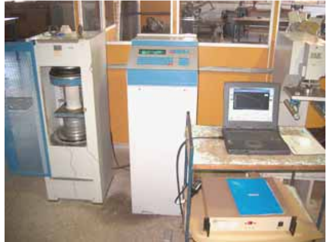
Figura 5.3 – Máquina de compressão, Sistema 5000 e computador para aquisição de dados.
