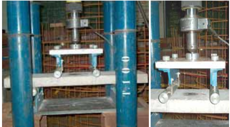
Figura 5.8 – Detalhes da viga 1 – Ensaio à flexão.
