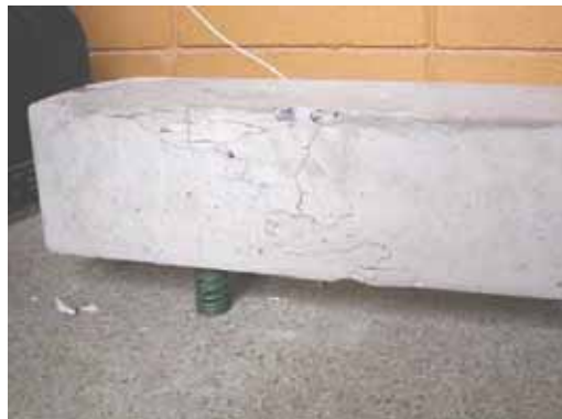
Figura 6.14 – Ensaio dinâmico – após a ruptura do corpo-de-prova.
