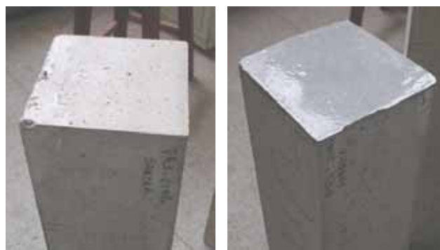
Figura 6.5 – Prismas antes e depois da aplicação de massa plástica para regularização dos topos.
