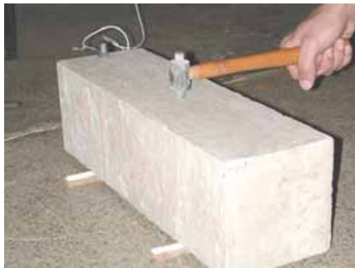
Figura 5.17 – Ensaio com o prisma – frequência transversal – madeira.
