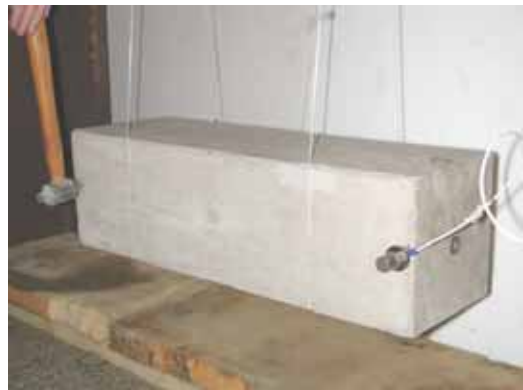
Figura 5.18 – Ensaio com o prisma – frequência transversal – suspenso por fios de nylon.
