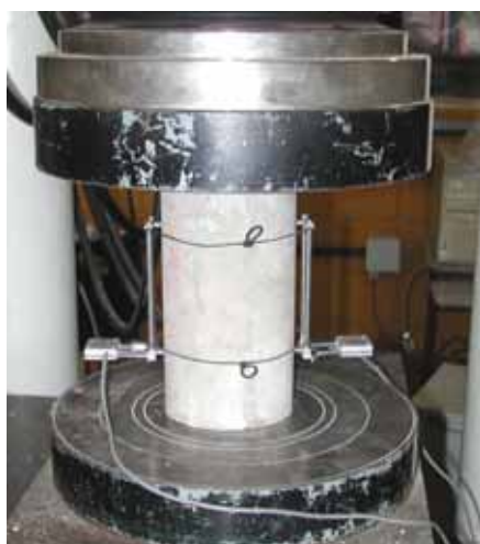
Figura 6.6 – Ensaio estático do CP cilíndrico na Instron.
