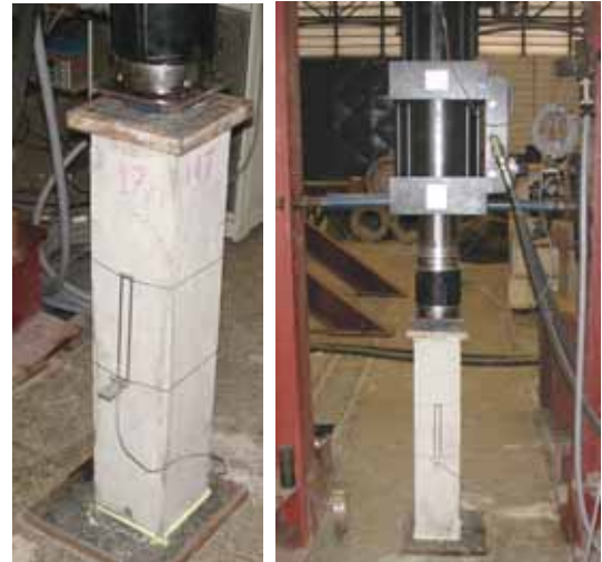
Figura 6.9 – Prisma sendo ensaiado no atuador servo-hidráulico.
