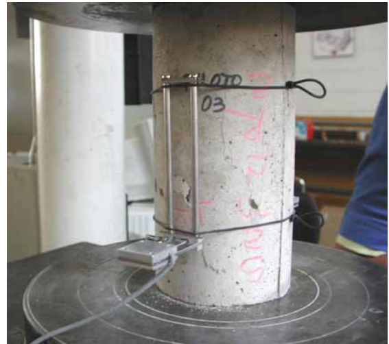
Figura 5.26 – Corpo-de-prova cilíndrico após a ruptura.
