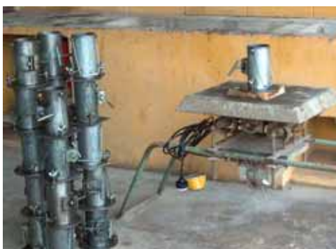
Figura 6.4 – Formas metálicas – CPs cilíndricos. Mesa vibratória.
