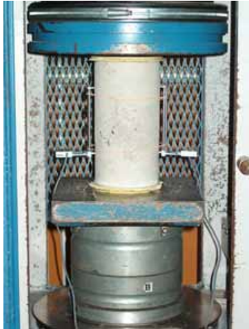
Figura 5.2 – Disposição dos extensômetros removíveis.
