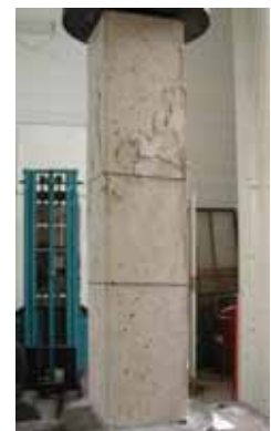
Figura 6.35 – Ruptura por esmagamento do concreto.
