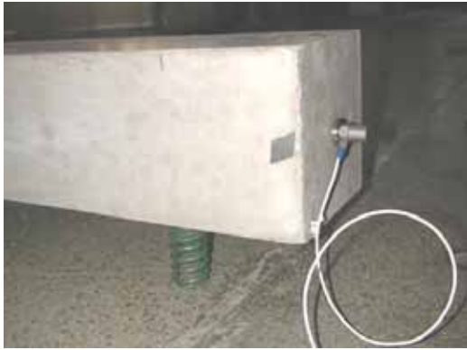
Figura 5.15 – Ensaio com o prisma – frequência longitudinal – molas.
