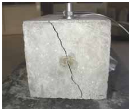
Figura 6.32 – Detalhes da ruptura do prisma – série AR, 124 dias.
