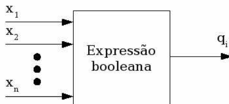
Figura 2.18: Modelo geral de uma malha combinacional
