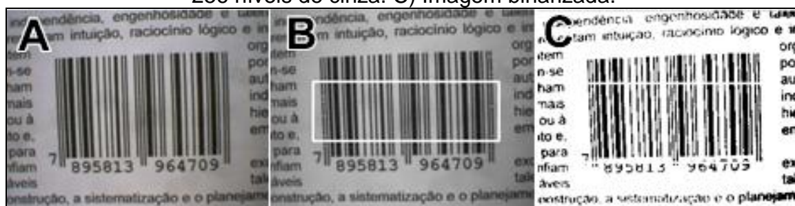
Figura 19. Resultados do pré processamento. A) Imagem original. B) Imagem com 256 níveis de cinza. C) Imagem binarizada.
