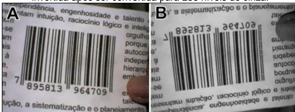
Figura 18. Imagens obtidas a partir da webcam . A) Imagem original. B) Imagem invertida após ser convertida para 256 níveis de cinza.
