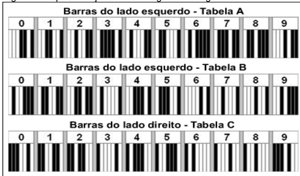
Figura 2. Representação de cada dígito do código na forma de barras.
