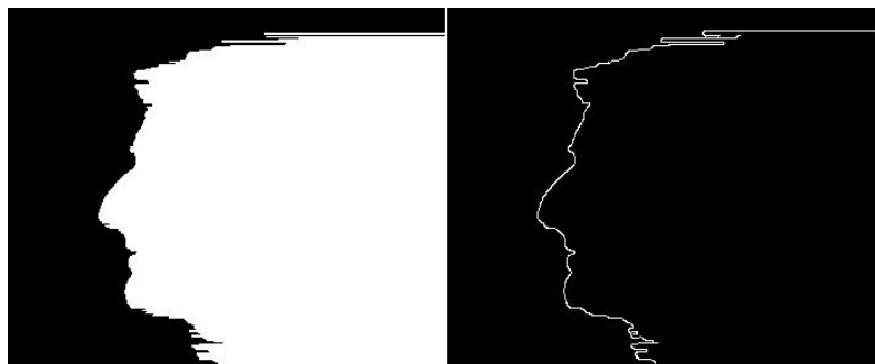
Figura 4.5: Imagem com o fundo em branco (à esquerda). Linha de perfil gerada pelo algoritmo Canny (à direita).
