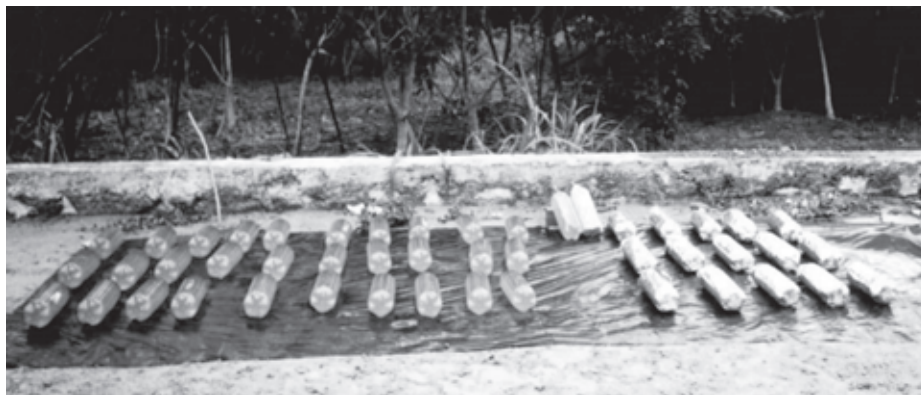
FIGURA 9 – Botellas irradiadas para validar los métodos SODIS y FH en Campina Grande, Brasil
