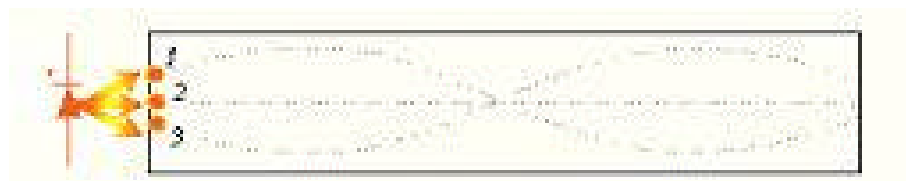
Figura 7 - Fibra Óptica – Modos guiados e dispersão modal
